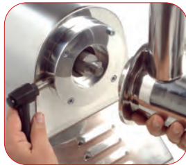
Modelo PI-32 con boca fácilmente desmontable para su limpieza.
