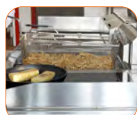
Sistema de fijación de la cesta para escurrir el aceite del cabezal.
