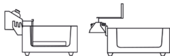
Fig. 4: Posición abatible del cabezal de fritura para extraer el aceite
