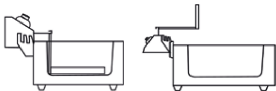
Rys. 4: Zawiasowa pozycja głowicy smażącej w celu usunięcia oleju
