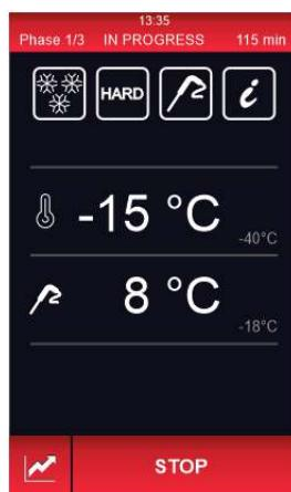
Ekran pokazuje podsumowanie cech trwającego cyklu. Naciskając obszar temperatury, wyświetlacz przełącza się na ekran, na którym można edytować wartości trwającego cyklu.
