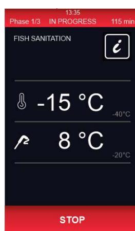
Cykl sanityzacji rozpoczyna się od fazy schładzania szokowego. Gdy temperatura zarejestrowana przez sondę igłową osiągnie temperaturę konieczną do schładzania szokowego, urządzenie automatycznie przejdzie w stan przetrzymania.
