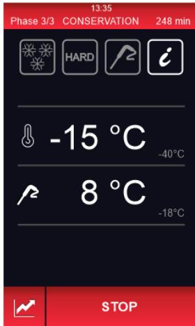
Si le cycle de température ne se termine pas dans le temps imparti, l'anomalie est signalée par l'icône d'alarme, mais le cycle de réfrigération rapide continue.
