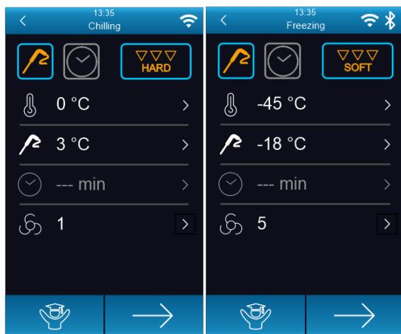
Le cycle sélectionné lancera les paramètres par défaut pour ce cycle, mais en appuyant sur la zone il sera possible de modifier les principaux paramètres affichés à l'écran en restant dans la plage sélectionnée. Pour régler tous les points définis des différentes phases prévues pour le cycle sélectionné, il est possible d'activer le mode Expert en appuyant sur la zone . Une fois les différents réglages effectués, il faut appuyer sur la
