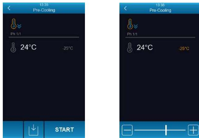
Ustaw wymaganą wartość nastawy i naciśnij obszar **START**, aby rozpocząć cykl wstępnego chłodzenia. Zostanie wyświetlony poniższy ekran pokazujący trwający cykl wstępnego chłodzenia.
