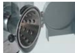
Stożek do ścierania mozzarelli (otwory 7 mm)
