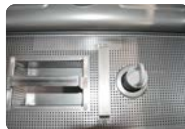
Filtr ze stali nierdzewnej w komorze myjącej
