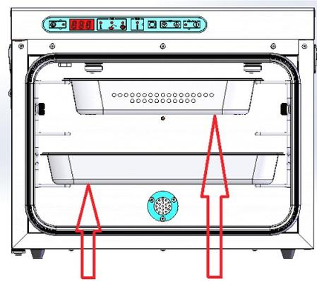
14. Ajuste de la puerta: Mueva los dos postes de la parte central hacia la izquierda y la derecha como se indica en la ilustración para realizar el ajuste.
