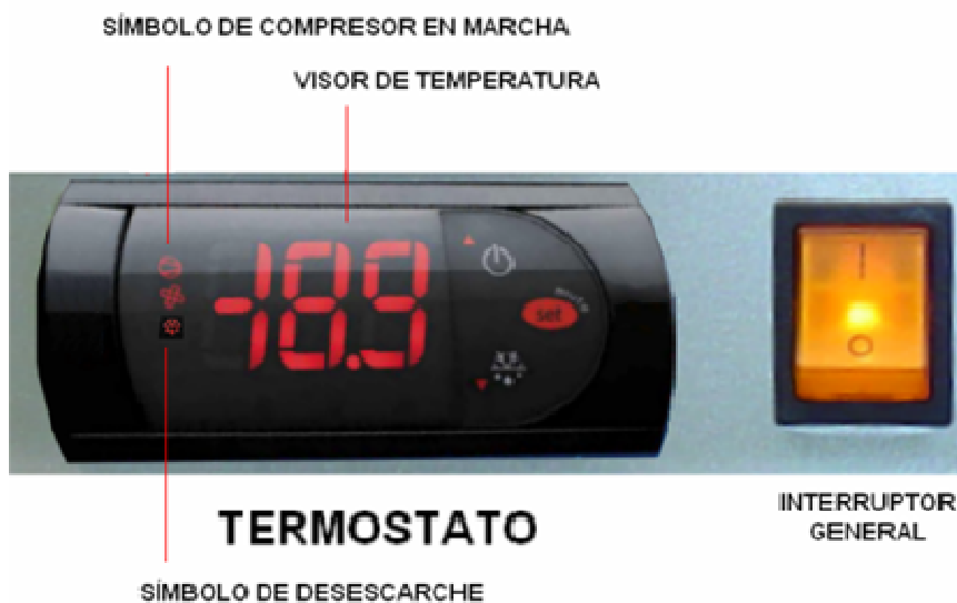
Cuadro de mando con interruptor y termostato
