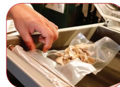
Envasadoras al vacío controladas por tiempo, con doble barra de soldadura de 400 mm.
