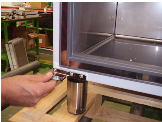
PASO 5: Cambio de soporte bisagra de apertura a izquierdas 6033010098 a derechas 6033010099
