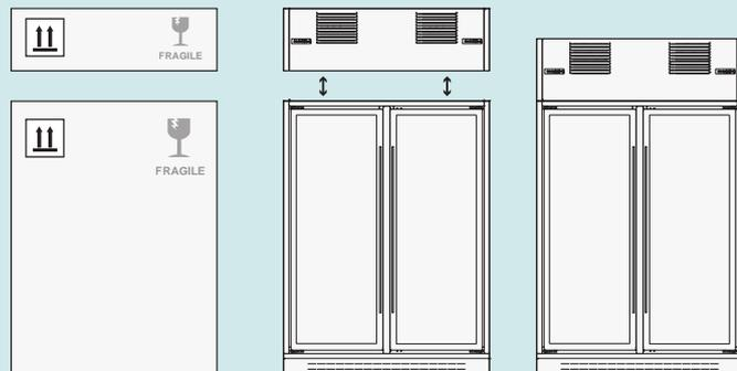
Para facilitar su manipulación, transporte e instalación, las vinacotecas se suministran en dos bultos. Durante la instalación, basta colocar el bloque de frío en la parte superior de la cámara, el bloque queda totalmente hermético.
