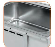
Baño María eléctrico de 1 cuba embutida con capacidad para cubetas **GN 1/1** hasta **165 mm** de profundidad. Temperatura regulable de **0° a 90 °C**.
