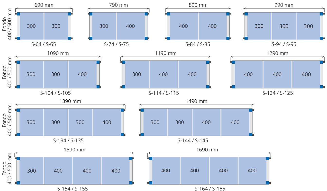
Los 11 largos diferentes de los estantes permiten, además del montaje independiente con 2 soportes, múltiples combinaciones mediante la colocación de **estantes por ambos lados de los soportes**. Ver tablas de conjuntos en las páginas 68-71
