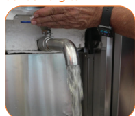
Grifo de vaciado con seguridad.
