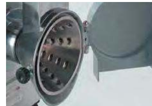
Stożek do ścierania mozzarelli (otwory 7 mm)
